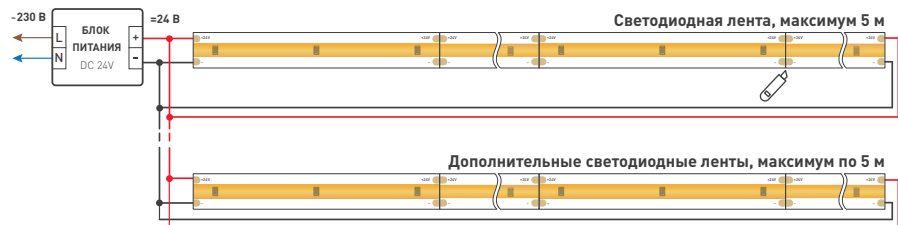
Схема 2. Подключение нескольких светодиодных лент с двух сторон Рекомендуется использовать для обеспечения равномерного свечения ленты по всей длине.
