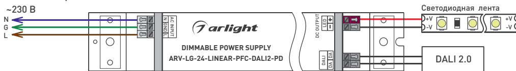
Рис. 1. Подключение источника питания при использовании интерфейса DALI 2.0
