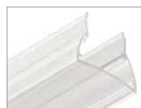
018820 Экран ARH-WIDE-(B)-H20-2000 TPZ Clear-PM Материал PMMA, светопропускание 90% Заглушки TPZ
