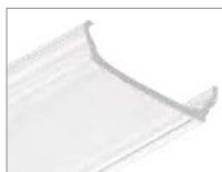
013293 Экран F прозрачный для PHS Материал PC (поликарбонат), светопропускание до 98% Прозрачный фигурный экран класса стандарт
