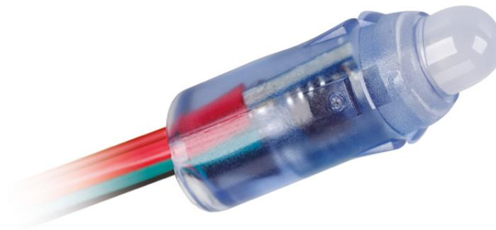
Герметичный широкоугольный управляемый RGB-модуль 8 мм. Угол освещения 180°. Посадочное отверстие Ø12 мм. 256 градаций яркости на канал. При подключении модулей учитывайте направление передачи сигнала, обозначенное на плате. Входной сигнал SPI.
